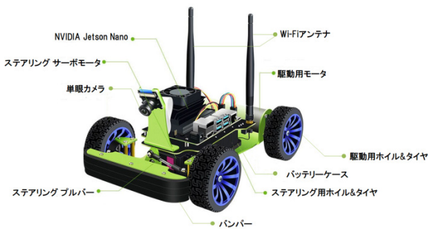
図-1 JetRacer の外観と主要機構
